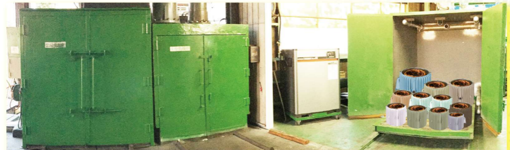
大型乾燥炉3基が大型コイルや大量のコイルの乾燥処理に威力を発揮します
